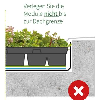
— Schutzvlies — Wurzelsperre — Bauseitige Abdichtung
